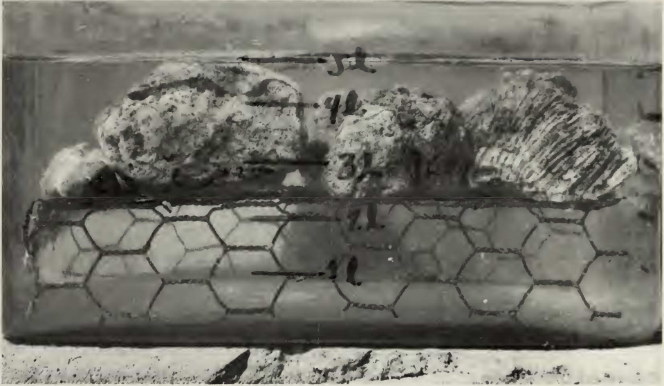
Fig. 2. Método para la extracción de los organismos de la criptofauna en artesas de cristal. Fig. 2. Method for the extraction of cryptofauna in laboratory glass containers.
